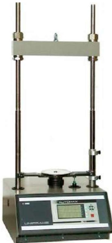
Рис.1. Пресс испытательный UNIFRAME 70-T0108/E
