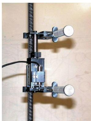
Электронный датчик, база измерения от 50 до 200 мм, линейность  $\pm 1\%$ .
