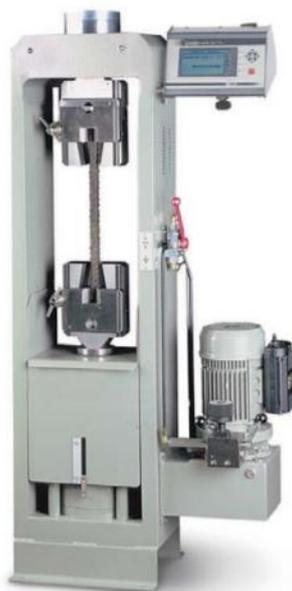
Полуавтоматическое цифровое устройство для испытаний на растяжение и сжатие с нагрузкой 500/1000 кН.
