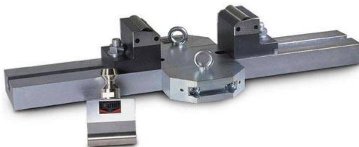
Нижняя балка с двумя подвижными опорами и одной верхней опорой.
