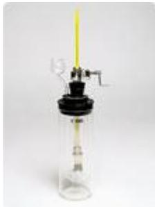
Устройство для испытания на изгиб с охлаждением
