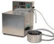
Для обеспечения воды с температурой  $25 \pm 0,1^\circ\text{C}$  для испытаний на проникание.
