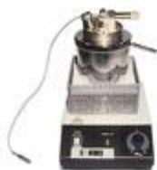
Электронагреватель с электронным регулятором.
