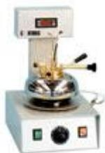
Электронагреватель с терморегулятором.
