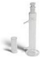
Слянка с притертой пробкой емк. 600 мл с двумя закрывающимися боковыми трубками.
