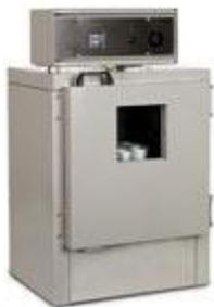
Испытание в тонкопленочной печи.
