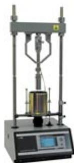
**70-T0108/E Универсальный цифровой испытательный пресс 50 кН для испытаний образцов асфальтобетона на сжатие с постоянной скоростью (3 и 50 мм/мин.) по ГОСТ, а также на сдвигоустойчивость по Маршаллу.**
