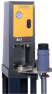
Для образцов размером 100 и 150 мм, регулируемый гирационный угол от 14 до 28 мрад.
