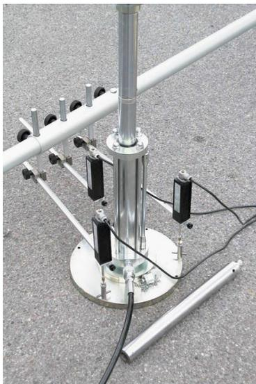
Штампы 300 или 300/450/600/760 мм, датчики смещения и устройство для сбора и обработки данных Datalog.
