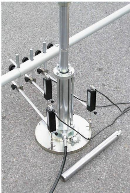
Штамп 300 мм, датчики смещения и устройство сбора и обработки данных Datalog.
