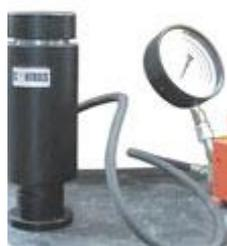
Гидроцилиндр, ручной насос с манометром, сферическая опора.
