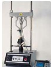
Датчик нагрузки на 50 кН, датчик смещения, поршень для определения CBR, устройство для сжатия и принадлежности.
