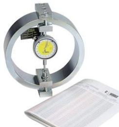
Весы-опоры, циферблатные индикаторы с креплениями, поршень для пенетрации, устройство для сжатия и т.д.
