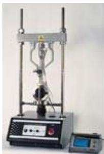
Тензодатчик для нагрузки 50 кН, датчик смещения, устройство для сжатия и принадлежности.
