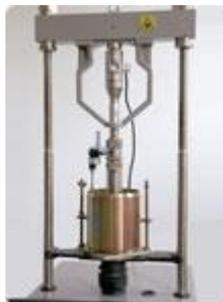
Тензодатчик для нагрузки 50 кН, датчик смещения, поршни и принадлежности для испытаний по определению CBR.
