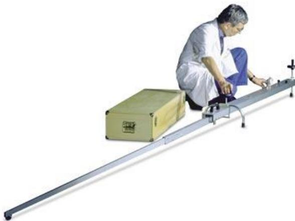
Алюминиевая опорная плита диам. 600 мм, гидроцилиндр 200 кН, ручной насос с манометром, устройство "балка Бенкельмана".
