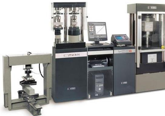
Многофункциональный блок, управляющий устройствами для испытаний на сжатие и изгиб (до 4 устройств)
