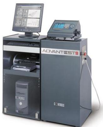
Многофункциональное устройство с улучшенными возможностями, используемое для управления работой рам для испытаний на сжатие и изгиб (до 4 рам). Управление нагрузкой/напряжением, перемещением и деформацией.
