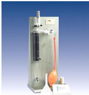
Ячейка из нержавеющей стали, U-образный стеклянный манометр.
