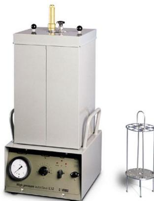
Сосуд высокого давления диам. 154 мм, высотой 430 мм со штативом для 10 образцов.
