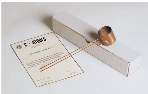
Разрезанный по образующей упругий полый цилиндр диаметром 30 мм и высотой 30 мм с двумя индикаторными иглами.
