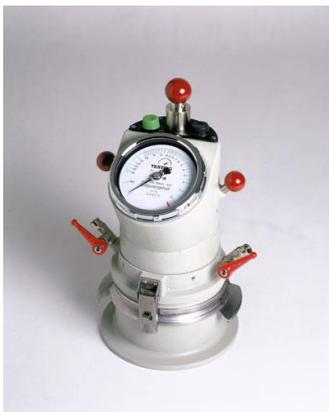
Литой алюминий, с объемной шкалой в диапазоне 0-50%. Модели емкостью 1 и 0,75 литров.
