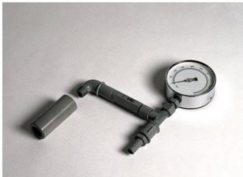
Распылительная насадка с 17 отверстиями, ситотканью и манометром.
