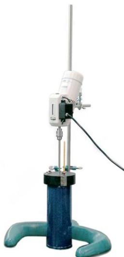
Емк. 1000 мл Сосуд Дьюара, моторчик с мешалкой и калиброванный термометр.
