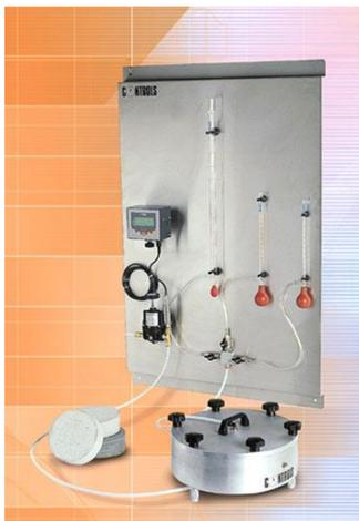
Диффузионная ячейка для бетонного образца диам. 150 мм и высотой 50 мм, устройство цифровой индикации, расходомеры для газа и принадлежности.
