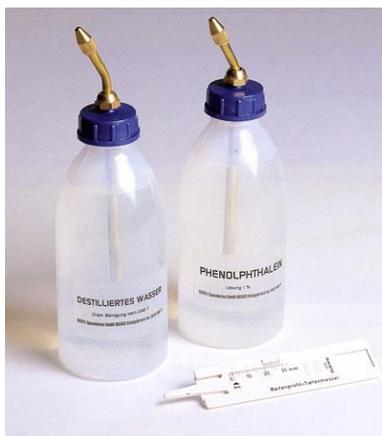
Включает дистиллированную воду, фенолфталеин и глубомер.
