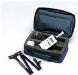
Датчик с хлорсеребряным электродом, автоматическое включение-выключение.
