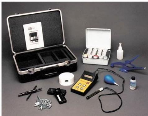
Полный набор для испытаний с электронным измерительным прибором, электродом, экстракционной жидкостью, смачивающим агентом и шкалой.
