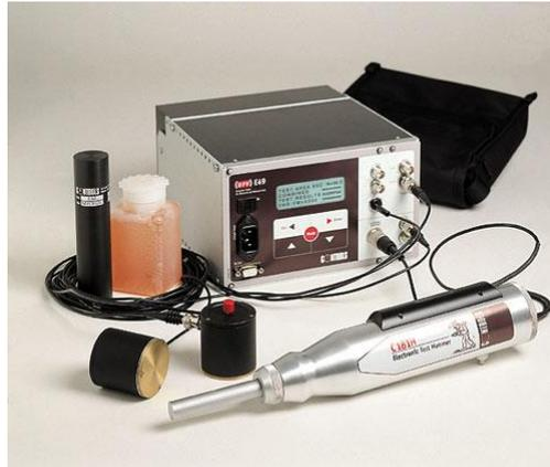
Два варианта: сверхмощная модель, включающая электронное устройство для определения упругого отскока, и стандартный вариант с ручным вводом результатов испытания по методу упругого отскока молотка.
