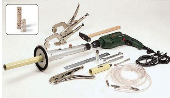
Включает алмазные буровые коронки для электрического бура с внутренним диам. 28 мм, направляющее устройство с фланцем и принадлежности.
