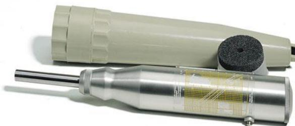
Наиболее распространенными неразрушающими испытаниями бетона являются испытания, которые дают возможность определить прочность при сжатии на месте работ.
