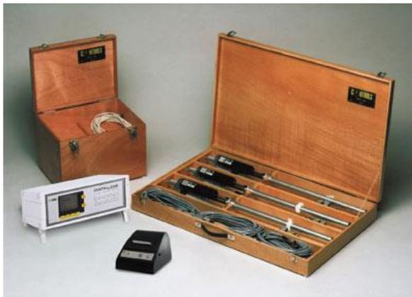
Включает 3 трубчатых датчика, 8-канальную систему сбора и обработки данных, последовательный принтер и принадлежности.
