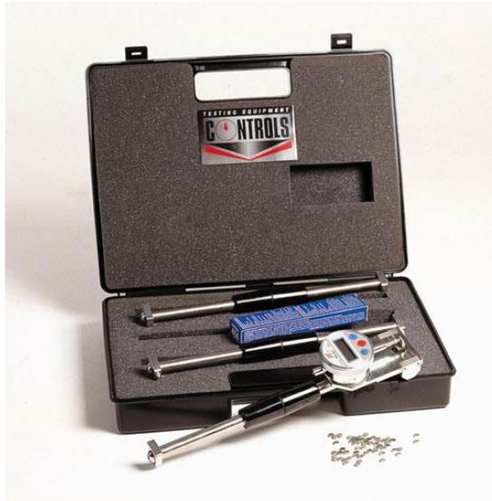
Длина базы измерения от 100 до 300 мм, в комплекте со стандартным стержнем, калибровочным стержнем, реперными дисками и клеевым составом.
