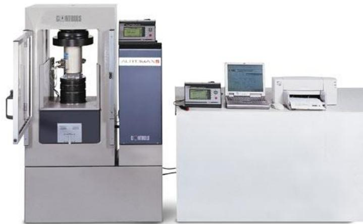
Нагрузка 3000 кН, в комплекте с пластиной для размещения по центру и дистанционными распорками. Для использования с цифровым тестером 82-P0804/E.
