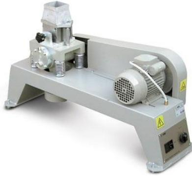
12000 циклов вибраций в минуту, стол, установленный на 4 пружинах.
