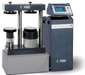
Автоматическое двухкамерное устройство для испытаний на сжатие, нагрузка 250/15 кН, со стандартными круглыми опорными пластинами.
