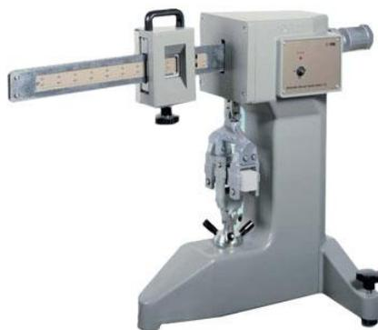
Система нагружения балки, двойной диапазон: нагрузка 1000 и 5000 Н.
