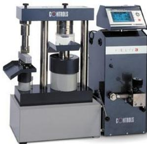
Полуавтоматическое устройство для испытаний на сжатие/изгиб, нагрузка 250/15 кН, встроенные опорные пластины для сжатия и зажимное приспособление для испытаний на изгиб.
