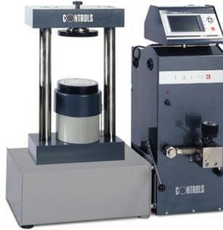
Полуавтоматическое устройство для испытаний на сжатие, нагрузка 250 кН, со стандартными круглыми опорными пластинами.
