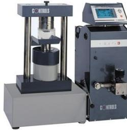
Полуавтоматическое устройство для испытаний на сжатие, нагрузка 250 кН, со встроенными опорными пластинами стандарта EN.
