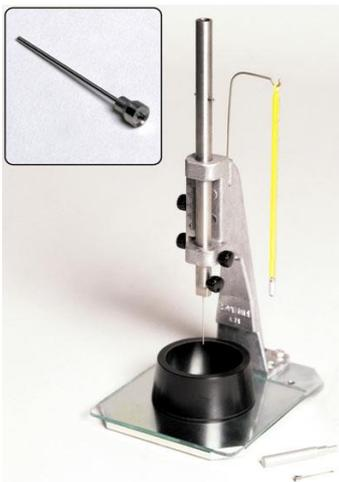
Металлическая станина со стержнем для скольжения, груз для испытаний, 300 г
