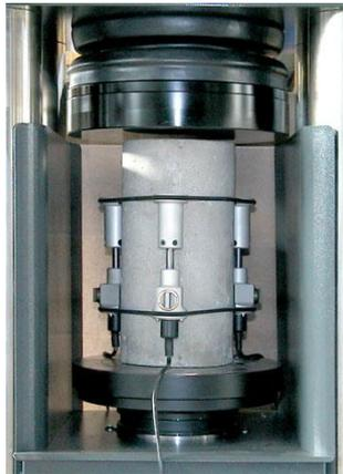
Для измерения осевой деформации.
