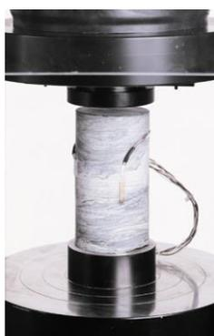
Статический модуль упругости - один из наиболее важных параметров для проектирования железобетонных конструкций и определения их деформационных свойств. Его определение осуществляется с использованием следующих приборов.
