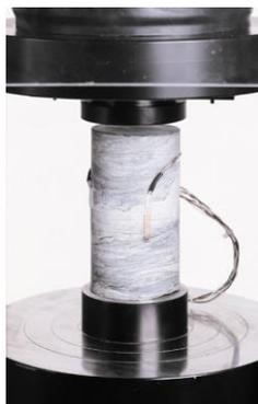
Для обнаружения деформации образцов бетона, цемента или горной породы при сжатии.
