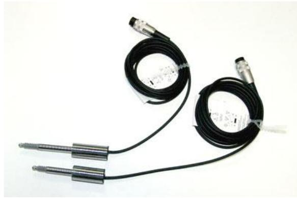
Высокоточные, индуктивные, LVDT-типа для измерения прогиба, смещения и раскрытия трещин в различных испытаниях.
