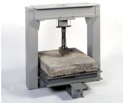
Предлагаемые приборы предназначены для исследовательских целей - для изучения улучшенной пластичности (ударопрочности) фибробетона в сравнении с неармированным бетоном.
