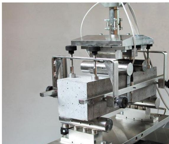
Для использования с рамой для испытаний на изгиб модели 50-C1201/\* и Advantest 9, автоматическим пультом управления.
