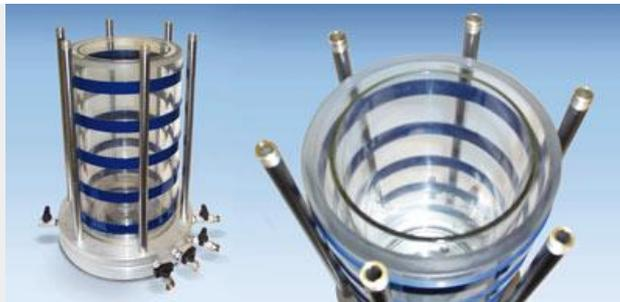
Камера трехосного сжатия с двойными стенками
