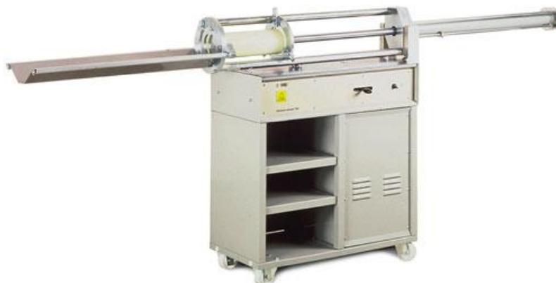
Мощность 60 кН, ход поршня 900 мм, горизонтальное извлечение.
