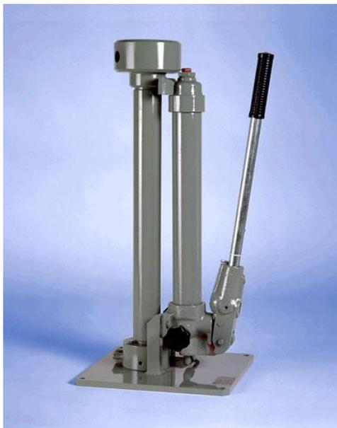
Гидравлическая система, 60 кН, ход поршня 480 мм.
