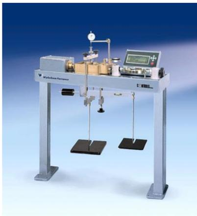
Прибор для испытания на прямой и остаточный сдвиг с цифровым управлением и выводом скорости.
