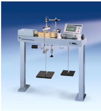
Прибор для испытания на прямой и остаточный сдвиг с цифровым управлением скоростью и сбором данных с помощью системы управления Automax.
