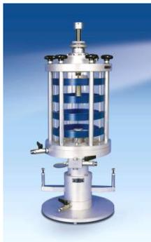
Тензодатчик, нагрузка 5 кН, диаметр образца 38-50 мм
