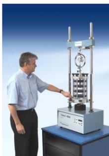
Нагрузка 50 кН, скорость испытания от 0,00001 до 9,99999 мм/мин.
