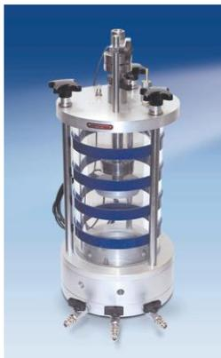
Макс. давление от 2000 до 3000 кПа, диаметр образцов 70-100 и 150 мм.
