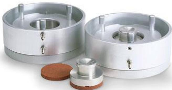
Модели с закрепленным кольцом и диффузионными ячейками.
