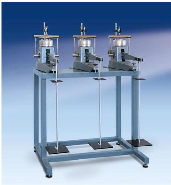
Передаточное отношение рычажного механизма 3, макс. нагрузка 1848 кг.
