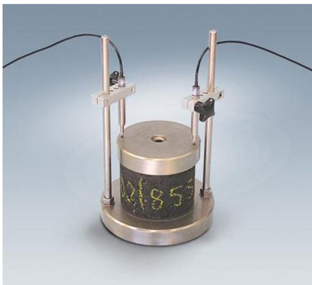
Включают зажимные устройства для испытаний на непрямоe растяжение и остаточную деформацию образцов диам. 100 и 150 мм, датчики и комплект для определения температуры.
