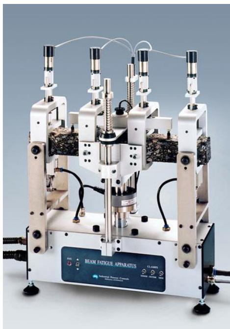
Автономная система, для образцов асфальта 50,8x63,5x400 мм.
