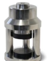
50-C9032/H Устройство для сжатия образцов кубической формы размером 50 мм (2") согласно ASTM C109
