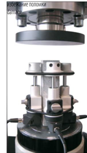
Три компрессометра-тензометра (50-C0222/F), установленных на призмер размером 40x40x160 мм.
