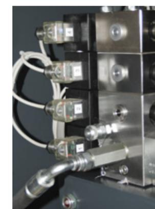
Гидравлические клапана 50-C10D/3F и 50-C20E/4F для подключения и управления четырьмя рамами
