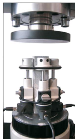
Цементная призма с тремя компрессометрами-экстензометрами 50-C0222/F
