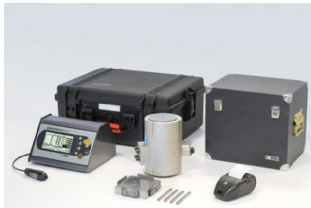
82-P0804/E с 82-E0105/1 и принтером 82-P0172/M. Колонна поставляется в комплектации с дополнительной пластиной и дистанционными распорками для быстрой и точной установки колонны центрально либо в положении, смещенном от центра на 6 мм. Она также может быть использована в качестве стандартного тензодатчика с нагрузкой 3000 кН для проверки точности приложения усилия.
