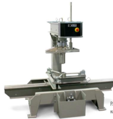
Рама для испытаний на изгиб 50-C1601/FR с комплектующими для проведения испытания
