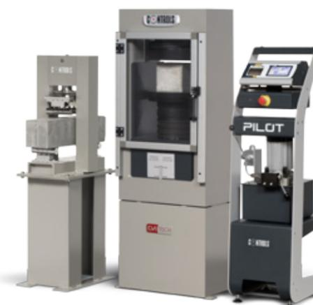
PILOT пульт управления линейки Smart для управления двумя рамами: для испытаний на сжатие и изгиб посредством гидравлического клапана 50-C10C/2F
