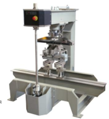
**Комплектующие** для проведения автоматических испытаний на изгиб при управлении нагрузкой
