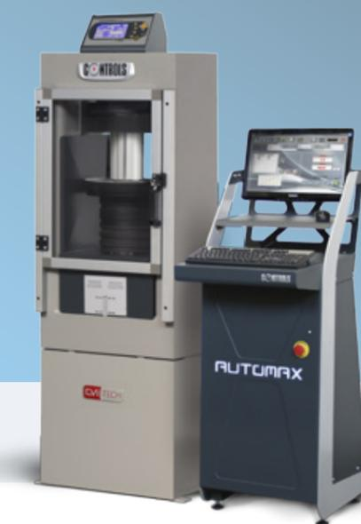
Пульт управления подсоединен напрямую через ПО к цифровому считывающему устройству и тензодатчикам для проведения автоматической проверки измерения нагрузки.
