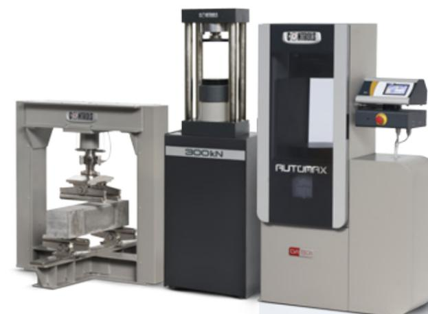
Установка для испытаний на сжатие AUTOMAX управляет рамами для испытаний на изгиб бетона и испытаний на сжатие цемента посредством гидравлического клапана 50-C10D/3F
