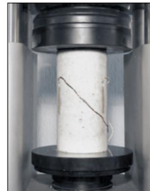
Бетонный образец с тензометрами
