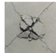
Типичная деформация под сосредоточенной нагрузкой
