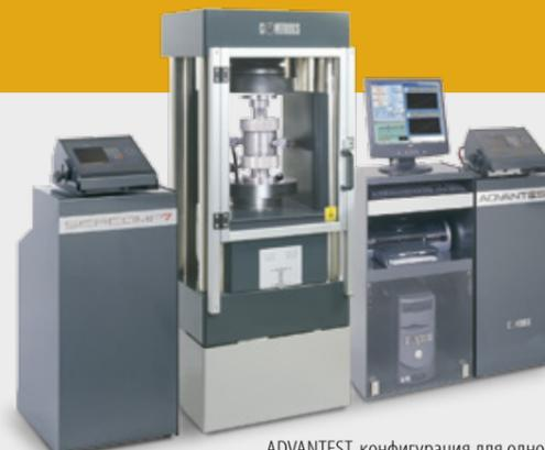
ADVANTEST, конфигурация для одноосных и трехкоординатных испытаний каменного керна
