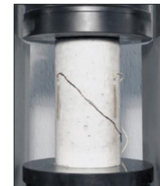
Определение модуля упругости посредством тензометров, установленных на поверхности образца
