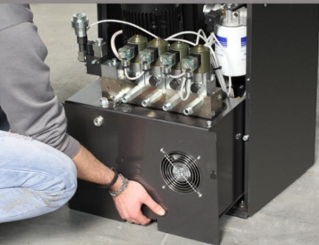
Задняя панель системы управления MCC. Четыре гидравлических порта для подключения рам хорошо видны (MCC оснащена двумя портами, которые можно расширить до 4).
