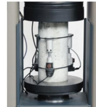
Три компрессометра-тензометра (50-C0222/F), установленных на образце цилиндрической формы во время этапа сжатия.
