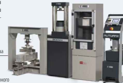
Система AUTOMAX линейки SMART с тремя рамами: рама для сжатия бетона, рама для сжатия цемента и рама для изгиба бетона
