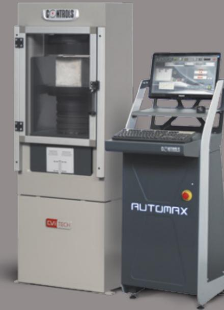
50-C20E82 AUTOMAX E-Модуль управляет рамой 50-C46Z00 на сжатие согласно стандарту EN, нагрузка 200 кН
