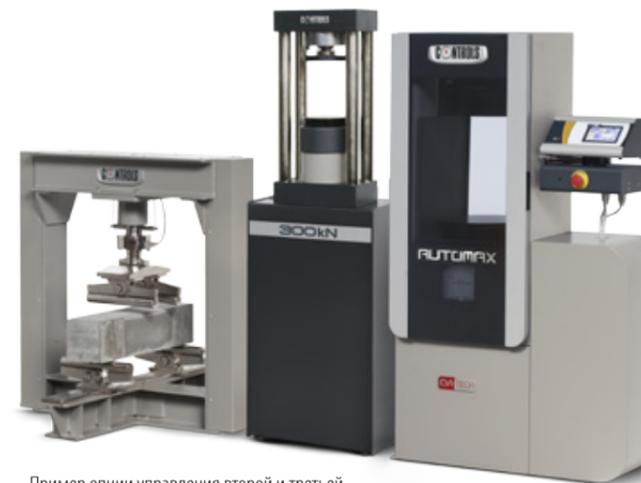
Пример опции управления второй и третьей рамами: 50-C42D02 подключена посредством 50-C10D/3F к рамам для испытаний на сжатие и изгиб цемента. Управление второй рамой входит в стандартную комплектацию.
