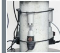
В модели AUTOMAX E-Модуль управление потоком масла встроено в прибор распределения потоком для проведения циклов нагрузки/разгрузки. Совместима с рамами низкой производительности (для испытаний образцов цемента и строительных растворов) и высокой производительности, используемых для бетона, высококонцентрированного бетона, бруса и керна.
