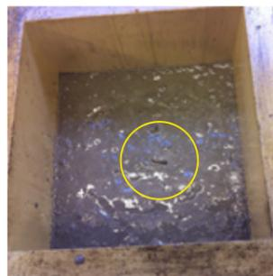
Микрочип (технология низких частот) внутри бетонного образца
