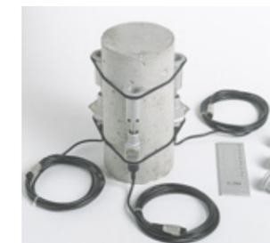
Три компрессометра-тензометра (50-C0222/F), установленных на образце цилиндрической формы (диаметр 150 мм, высота 300 мм) для испытания на модуль упругости.
