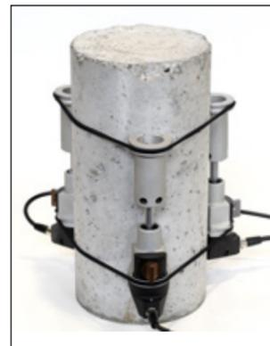
Бетонный цилиндр с тремя компрессометрами-экстензометрами 50-C0222/F
