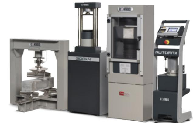
AUTOMAX пульт управления линейки Smart для управления тремя рамами: для испытаний на сжатие и изгиб бетона и сжатие цемента посредством гидравлического клапана 50-C10D/3F
