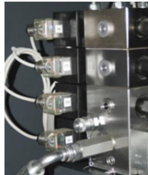
50-C20E82 с 50-C10D/3F и 50-C20E/4F: гидравлические клапана для подключения и управления третьей и четвертой рамами
