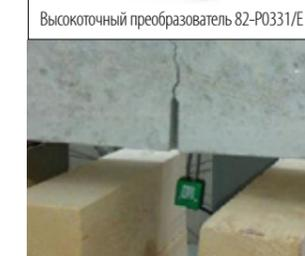
Испытание на образование трещин CMOD
