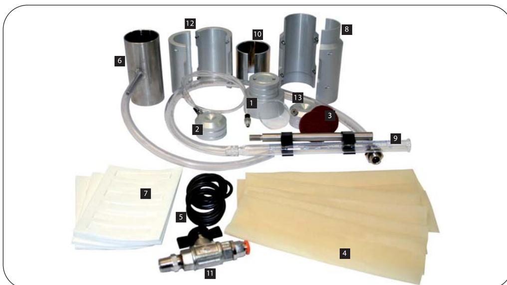
**БАНДАЖИРОВАННЫЕ ТРЕХОСНЫЕ ЯЧЕЙКИ****ДЛЯ ОБРАЗЦОВ ДИАМЕТРОМ до 150 мм**
