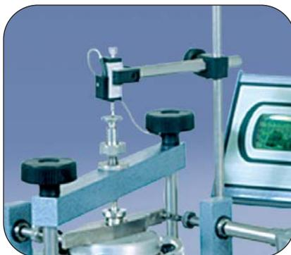
30-WF6207 Линейный потенциометрический датчик, ход 10 мм, с блоком монтажа
