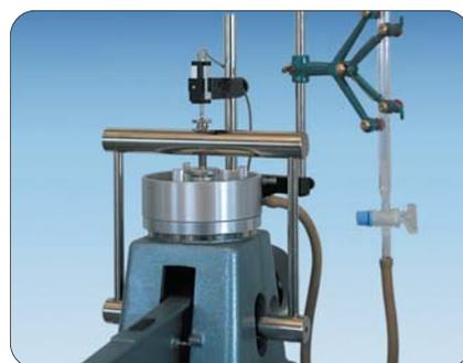
26-WF0338/A, прикрепленное к одометру 26-WF0302 с устройством 26-WF0320
