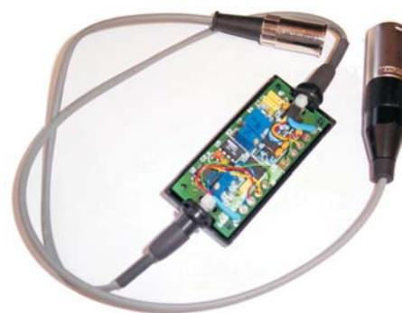
Встроенный модуль калибровки для датчиков, используемых в системах динамических испытаний
