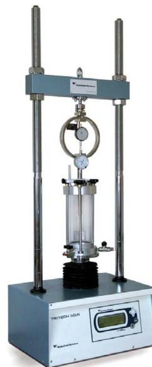
TRITECH 28-WF4005 со стандартной ячейкой для трехосных испытаний 28-WF0410/A, кольцом нагрузки и циферблатным индикатором
