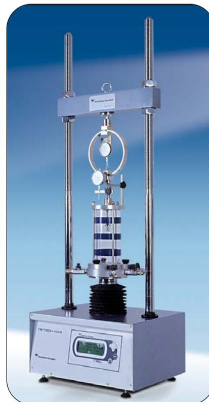
TRITECH 28-WF4005 с бандажированной ячейкой для трехосных испытаний 28-WF4050, кольцом нагрузки и циферблатным индикатором
