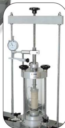
Устройство 28-WF0493. Конструкция верхней рамы с верхней ручкой для регулировки и выравнивания рычажного устройства для разных трехосных ячеек. Пластина основания также подходит для трехосных ячеек других типов, при условии, что у них имеется центрирующее отверстие диаметром 13 мм и глубиной 3 мм.
