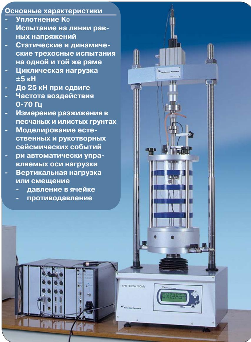
Система для трехосных динамических испытаний 31-WF7050 с ячейкой 28-WF4070/P TRI-CELL Plus
