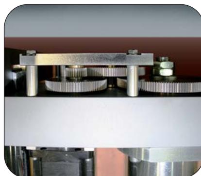
Устройство сдвиговой коробки. Система сконструирована таким образом, что вибрации минимизируются и обеспечивается плавность передачи
