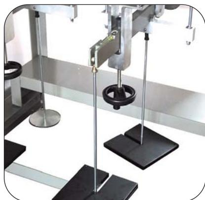
Конструкция 28-WF0493 для рычажного нагружения с плечом 10:1
