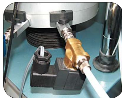
Устройство электромагнитного клапана для проверки коэффициента  $B$
