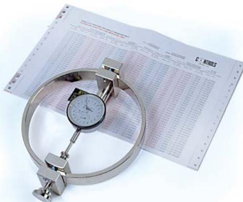
Кольцо нагрузки с коническим разъемом 28-WF1049 и поверочным сертификатом
